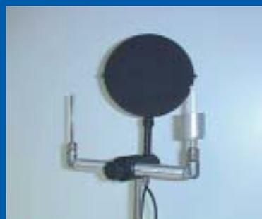
Esta sonda, según la norma UNE EN 27243 citada anteriormente, exige la medición de la T<sup>a</sup> seca o ambiente, T<sup>a</sup> húmeda natural y T<sup>a</sup> radiante para, finalmente, calcular el índice WBGT. En Testo lo que hemos fabricado ha sido una sonda que cumple al
